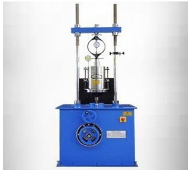
Fig 5.6: CBR Test Apparatus(google)
